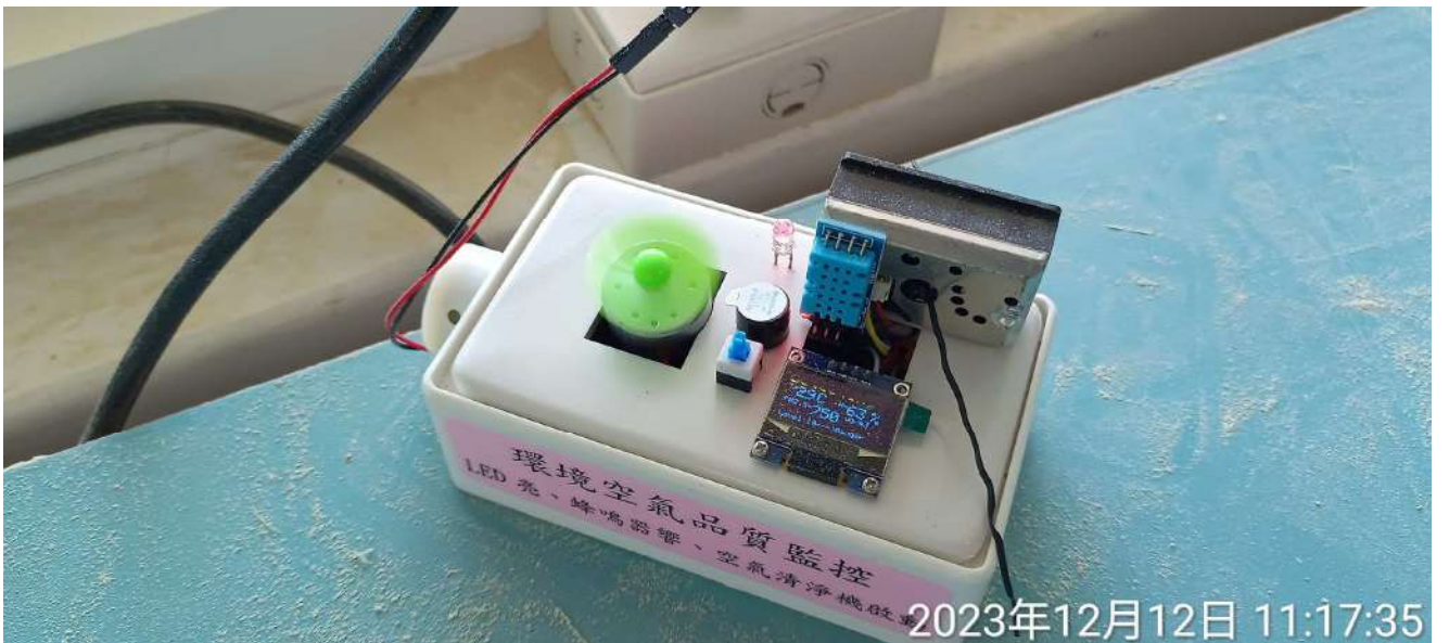
圖：生活科技課程 木工砂磨機加工木料作品時 環境空氣品質偵測 112.12.12
