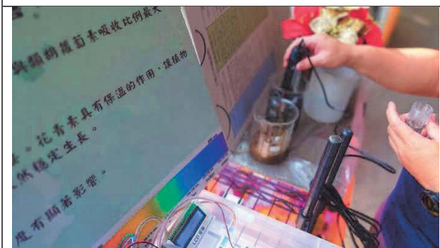
用酸鹼值測試計測市售肥料的 PH 值
