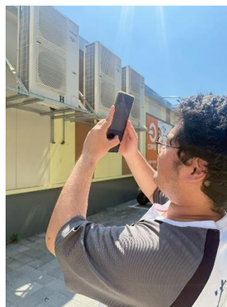
熱顯像儀操作之空調排熱量測 2
